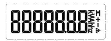
Zur Anzeige der Wirkleistung (kWh) werden keine unnützen nullen vor dem Komma angezeigt. Die Anzeige baut sich im Laufe des Betriebs nach und nach von 1+2 stellig bis 6+1 stellig auf.
